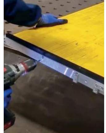
12 Mit den Schrauben beide Seitenwinkel befestigen und fest anziehen.
