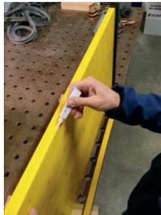
23 Zwei Linien Kleber auf die Schalttafel auftragen.
