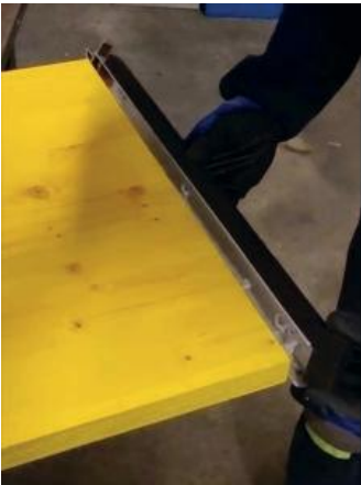
10 Achten Sie beim Aufsetzen des zweiten Winkels darauf, dass die Dichtungen auf derselben Seite sind.
