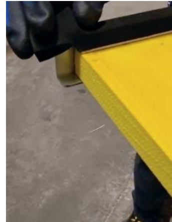
9 Die Kante des Seitenwinkel unter der Dichtung mit der Schalttafel ausrichten.
