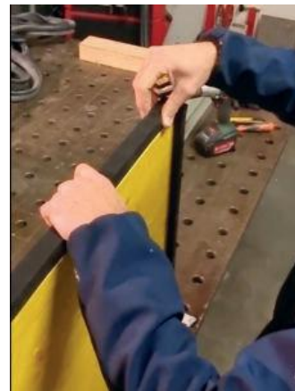
24 Nach dem Abziehen der Schutzfolie die Dichtung aufsetzen und sie gegen eine der beiden Seitendichtungen drücken. Anschließend die Dichtung aufkleben.
