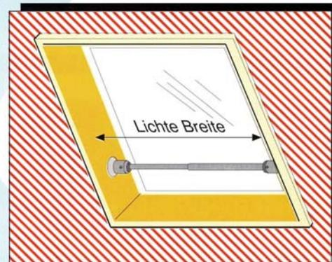
Eingesetzte Sicherheit an Dachfenstern und Lichtkuppeln.
