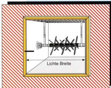
Lichtschaft - Sicherung mit aufmontierten Gitterrosthaltern und Stahligel (paßt auf jede Teleskopstange)
